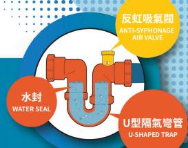
接駁隔氣彎管的反虹吸管/反虹吸氣閥 的作用是平衡氣壓,當上層單位排放的 污水量達到某一水平時,會產生虹吸 效應,令下層單位的分支渠管出現負氣壓, 足以抽走單位衞生設備隔氣彎管內的 不少於1米之上,且不會密封,空氣便可經 反虹吸管流入所接駁的分支排水管內, 平衡虹吸效應造成的氣壓差,防止隔氣 彎管內的水封流失,確保隔氣彎管有效 運作,而反虹吸氣閥的作用與反虹吸管
