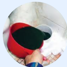
排水渠色水測試
