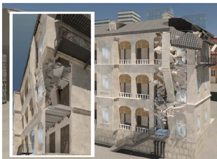
電腦模擬內部和外部磚牆倒塌
