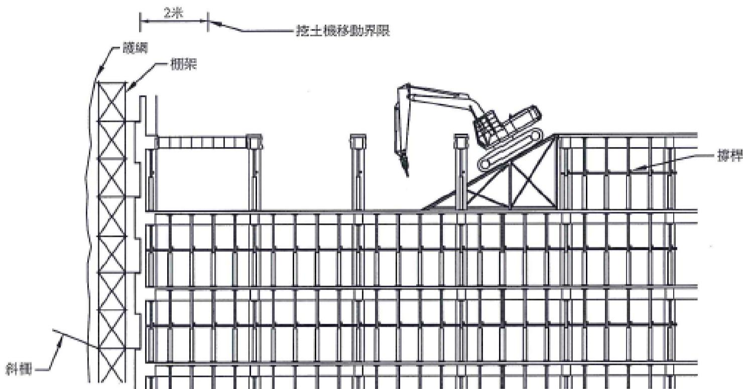
三. 由鋼結構框架或其他合適材料築成並妥為設計和支撐
