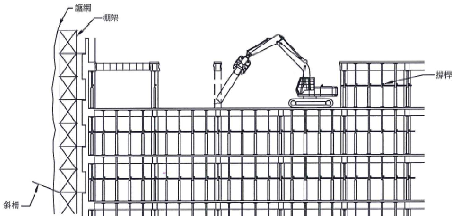
四. 可能需要拆卸內柱以形成拆卸外牆所需通道和工作空間
