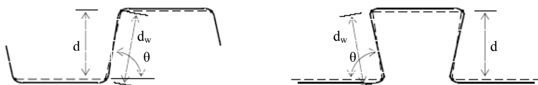
圖 11.2b 壓型鋼板的理想截面
